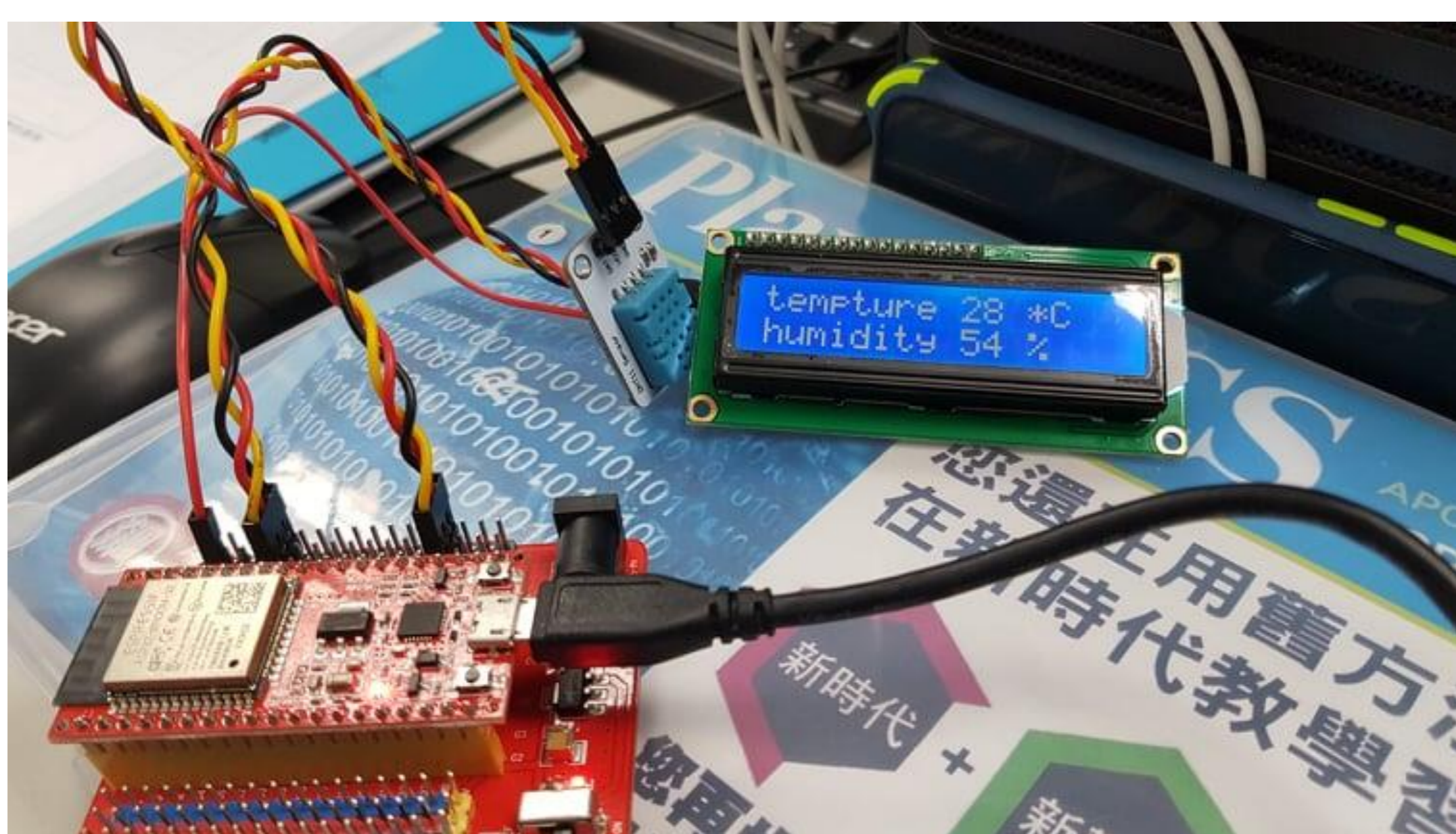
溫溼度感應器與LCD接線圖
